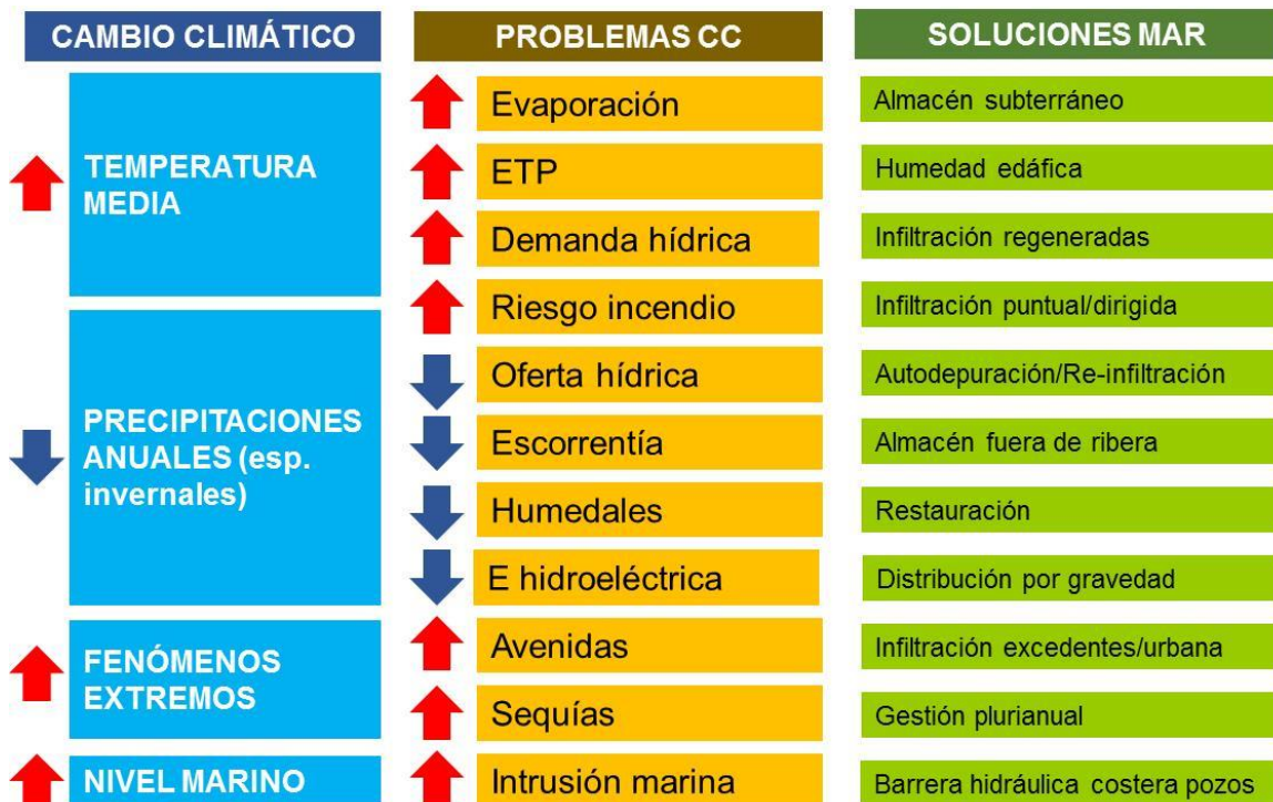
Figura 6. MAR como medida de adaptación al cambio climático (incluso mitigación). Manifestaciones principales, problemas asociados y cómo la recarga gestionada de acuíferos permite reducir el impacto de estos vectores. Tomado de Fernández-Escalante et al. , 2019 [10].
